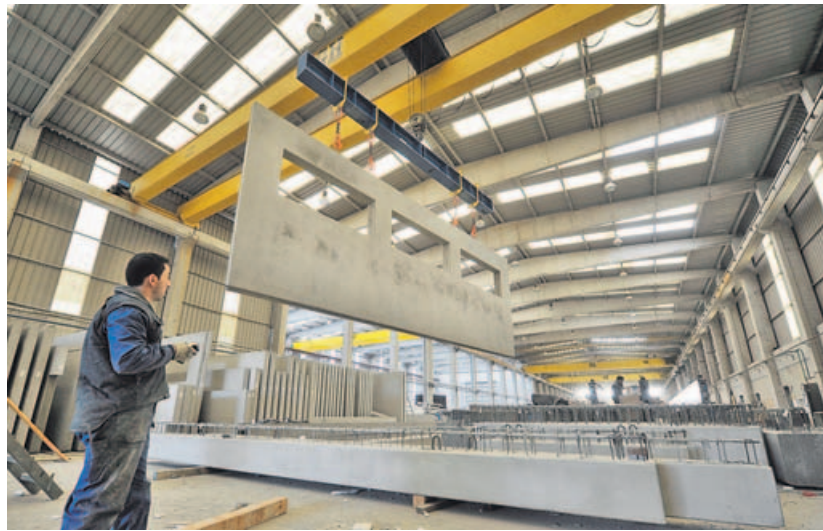
Un operario desplazando una estructura de hormigón prefabricado en la nave de la empresa dezana. | MIGUEL SOUTO
